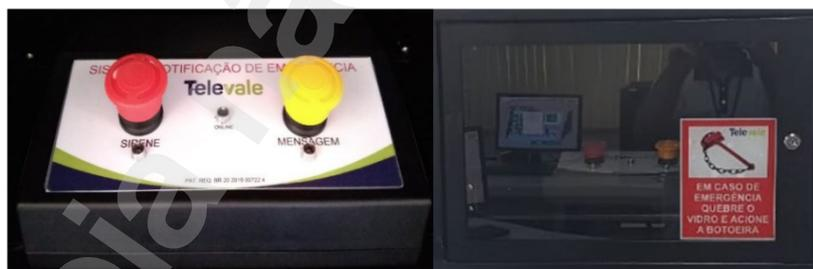
Fig. 06 – Exemplos de Dispositivo de Comando Físico (DCF).
